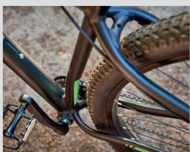
Om de lengte van de achtertrein enigszins binnen de perken te houden, is de staande buis voorzien van een subtiele knik.
